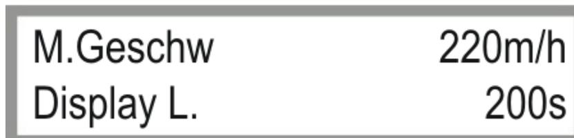
Bild 5.1.6: Einstellen der Max Geschwindigkeit und der Hintergrundbeleuchtung
