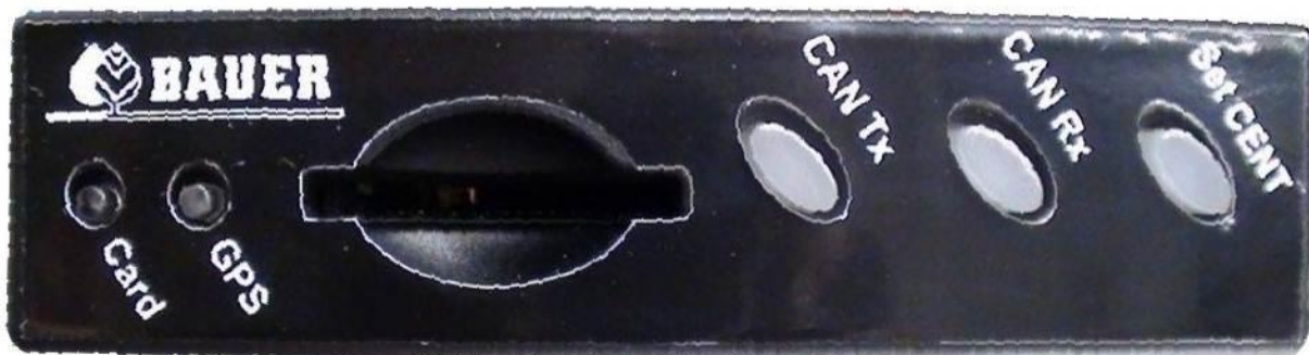
Fig. 2.2: Buttons of GPS module
