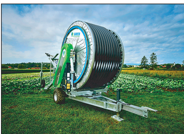
Bei der neuen Generation des Beregnungssystems Rainstar E lässt sich das Getriebe leichter schalten und ein neues Energiekonzept - mit einem größeren Solarpanel und einer stärkeren Batterie - macht längere Standzeiten möglich.
