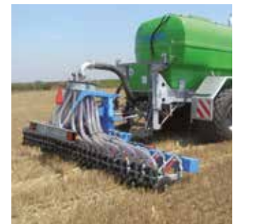
Injecteurs à lisiers Injecteurs à disques, à dents ou à charrues
