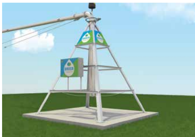
Tour centrale fixe
