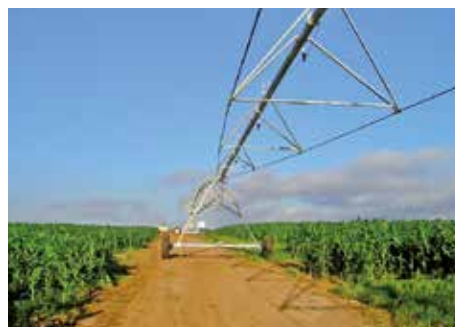
Déplacement rapide grâce au système simple de rotation des roues de la tour
