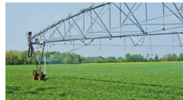
Grâce à la régulation de sa vitesse d'avancement en continu, le Corner offre une répartition parfaite de l'eau.
