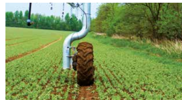
Commande exacte de la travée Corner par GPS ou câble souterrain.
