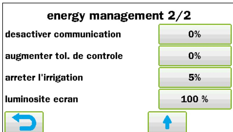
**Désactiver la communication:** Si la capacité de batterie était au-dessous de cette valeur pendant un intervalle prolongé, la communication par SMS ou SmartRain sera désactivée et le modem sera arrêté. Si l'ECOSTAR était réglé à SMS, un message sera envoyé auparavant.
