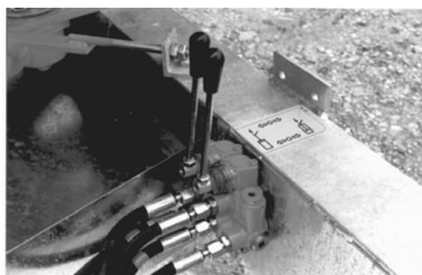
Hacer introducir y salir los soportes de la máquina, se facilita esencialmente utilizando la OPCIÓN „bloque de válvulas de mando – sistema de apoyo“
