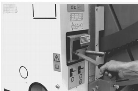
Poner la palanca de desconexión en posición „extracción del tubo PE“ .
