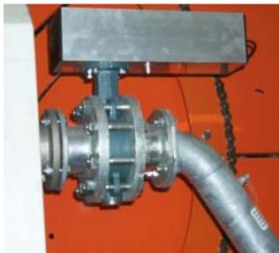
Con la válvula de desconexión por sobrepresión se impide totalmente la alimentación de agua después de terminar el proceso de riego. Al cerrar la válvula aumenta la presión en el conducto de aflujo.
