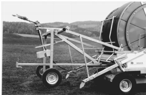
Una vez terminada la retracción del tubo, los soportes pueden ser introducidos cuidadosamente mediante la hidráulica del tractor, elevando automáticamente el trineo y poniéndolo en posición de transporte.
