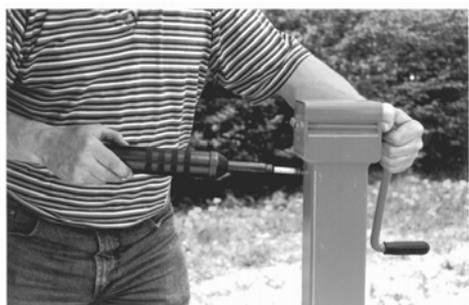
Lubricar con aceite o con grasa la pata de apoyo de la lanza.
