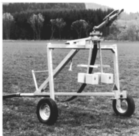
Los trineos a ruedas, por su elevada forma constructiva simétrica y asimétrica, son especialmente idóneos para el cultivo (el trineo a ruedas asimétrico de opción). El ancho de vía entre las ruedas puede ajustarse de forma continua y posibilita su adaptación a cualquier distancia de las filas del cultivo. El ajuste se hace simétricamente a través del sistema de soporte del bastidor.
