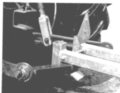
Los trineos están dotados de un gancho doble de extracción para extraer el tubo PE con más facilidad. La barra de enganche del tractor se fija en este gancho para extraer el tubo PE.
