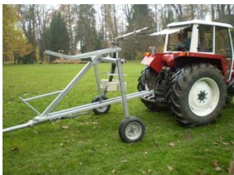
Le traîneau est équipé d'un crochet pour faciliter le déroulement du tuyau PE. La barre de traction du tracteur s'accroche dans ce crochet et le tuyau PE déployé. Pour tourner le tambour ou pour déplacer le RAINSTAR dans une autre position, le traîneau doit être rentré dans sa position finale sur l'appareil.
