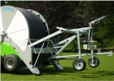
La sortie des appuis fait automatiquement descendre le traîneau en position « Déroulement tuyau PE ».
