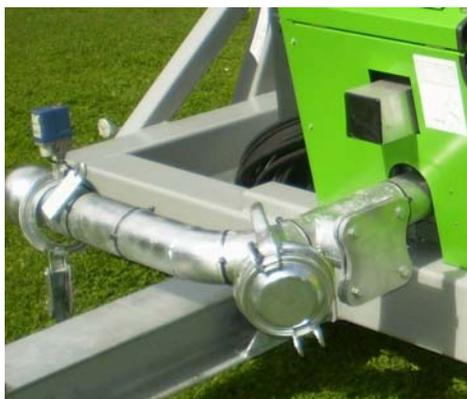
Le clapet d'arrêt à surpression coupe l'alimentation en eau intégralement à la fin de l'opération d'arrosage. Lorsque le clapet ferme, la pression augmente dans la conduite d'alimentation.
