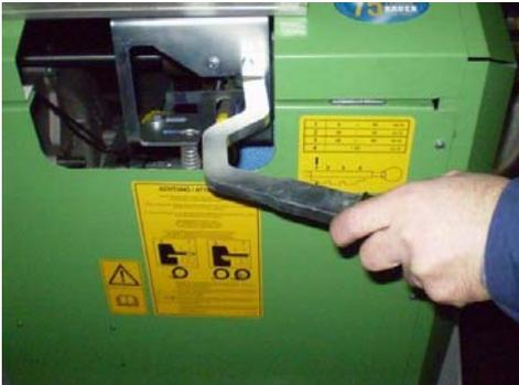
Lorsque la pression de service est atteinte et que l'arroseur à grand débit produit seulement un jet puissant exempt de bulles d'air, mettre le levier de changement de vitesse en position « Enroulement tuyau PE ».
