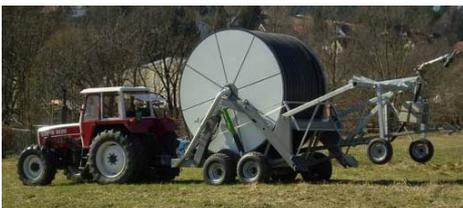
Pendant le transport, le traîneau se trouve en position levée sur le cadre de relevage. Les béquilles de l'appareil sont rabattues vers le haut et l'appui de la barre d'attelage est complètement rentré. Amener le RAINSTAR au lieu d'installation. Lors de la dépose du RAINSTAR, veiller à ce que le pivot vertical de l'appareil se trouve arrêté au centre de la bande d'arrosage ou de deux rangées de culture.
