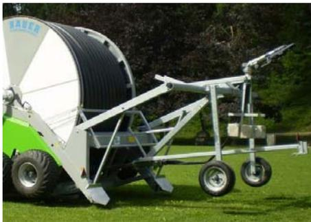
Une fois l'enroulement du tuyau effectif, il est possible de rentrer les béquilles arrière prudemment à l'aide du système hydraulique du tracteur, ce qui entraîne automatiquement le relevage et la mise en position de transport du traîneau.
