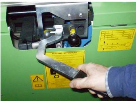
Placer le levier de commande de l'engrenage en position « Déroulement tuyau PE ». Un ressort pousse le levier de commande vers le haut et le bloque dans un cran.
