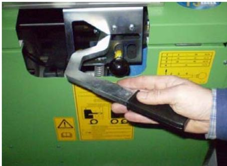
2. Tirer le levier d'arrêt en position d'arrêt et le pousser lentement et prudemment...
