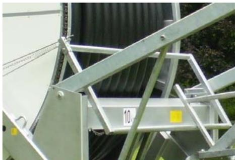
Pour que l'appareil ne nécessite pas de surveillance pendant l'opération d'arrosage, il est équipé d'un arrêt final et d'un arrêt de sécurité. L'arrêt final réagit dès que le traîneau pousse contre l'étrier qui actionne le levier d'arrêt par l'intermédiaire d'une tringlerie. Ceci arrête l'entraînement pour éviter des conséquences néfastes d'un tuyau PE mal enroulé.
