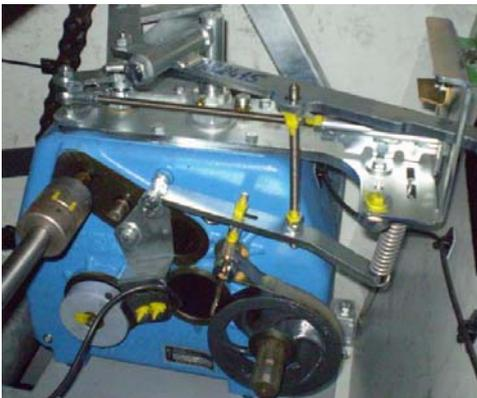
La boîte de vitesses BAUER démultiplie la vitesse de rotation de la turbine en fonction de la vitesse de rotation réglée. La boîte de vitesses comporte 4 niveaux. Le désaccouplement de l'accouplement à dents assure l'arrêt de l'entraînement du tambour à la fin d'une bande d'arrosage.
