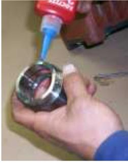
Gewinde mit Loctite benetzen
