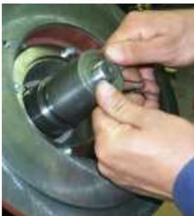
Hinaufdrücken der Gleitringdichtung mittels Hülse. (Hülse wieder entfernen ).
