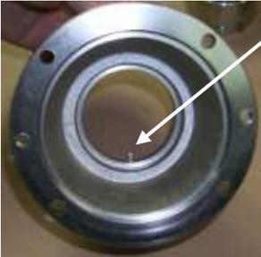
**Montage der Verdrehsicherung für Gegenring im Dichtungshalter nicht vergessen**
