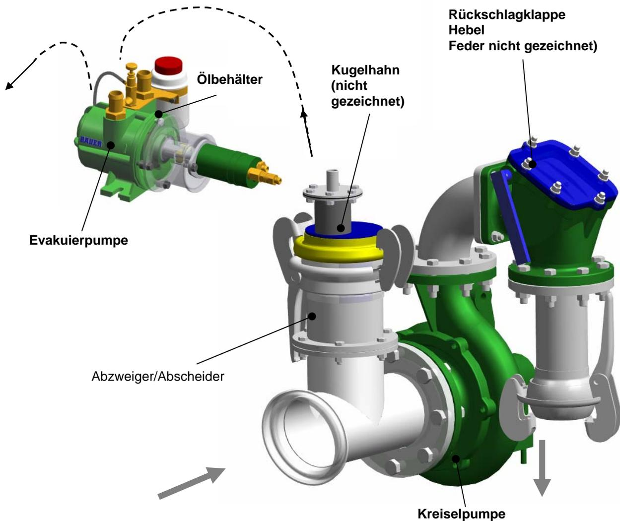
Die **Kreiselpumpe** kann das Medium (Wasser bzw. Gülle) nicht selbsttätig ansaugen - das übernimmt die Selbstsaugereinrichtung.
