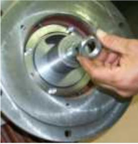
Mutter zur Fixierung der Distanz - Einbaulänge 47,5+/-0,5mm montieren.
