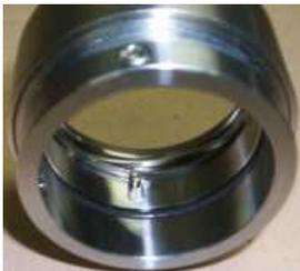
**Bei der Montage des rotierenden Teiles ist auf die Flucht von Stift u. Nut zu achten** (bei Fluchtungsfehler wird unter Kraftaufwand der Stift verbogen u. verdrückt die Feder, dadurch ergibt sich eine zu große Vorspannkraft der Gleitflächen ).
