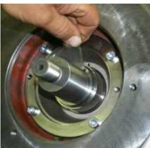
Entfernen des Klebebandes
