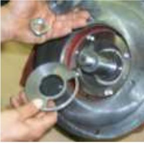
**Montageset zum Einstellen d. Funktionslänge der Gleitringdichtung**
