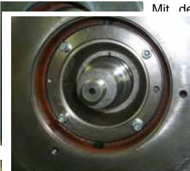
Mit dem Imbusschlüssel die mit Loctite benetzten Gewindestifte anziehen.
