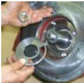
**Jeu de montage** pour l'ajustage de la longueur de la garniture mécanique étanche
