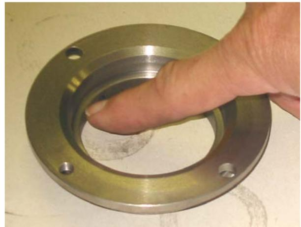
1. Mesurer l'écart « A » entre niveau anneau support 343 0202 et niveau bride d'engrenage
