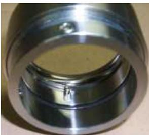
**Lors du montage de l'élément tournant veiller à ce que le goujon et la rainure sont bien alignés** (en cas d'un mauvais alignement le goujon est plié sous l'effet de la force et le ressort est mal comprimé, d'où résulte une contrainte excessive exercée sur les surfaces de frottement).
