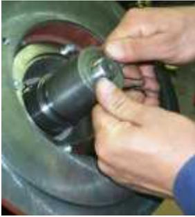
Mise en place de la garniture mécanique étanche à l'aide de la douille (retirer la douille après).
