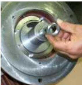
Monter l'écrou pour fixer la douille d'écartement - longueur de montage 45+/-0,5mm
