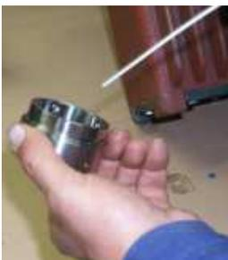
Mouiller la face intérieur de l'anneau joint avec du lubrifiant.
