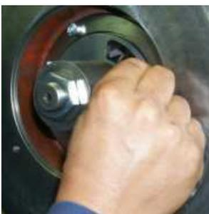
Serrer (fixer) les goujons filetés mouillés de la Loctite au moyen de la clé pour vis à six pans creux
