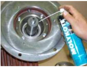
**Appliquer de la Molykote afin de réduire le frottement des anneaux joints**
