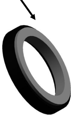
Abbildung 15: ESP Gegenring ohne Verdrehsicherung
