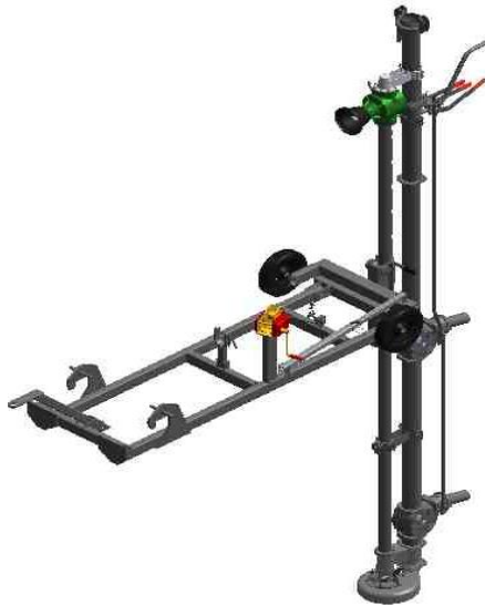
Elektropumpaggregat MAGNUM SX SX 2600 inklusive Elektromotor und Selbstsaugereinrichtung
