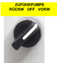
Abbildung 22 Hebel und Schalterstellung im Handbetrieb mit Klarlaufpumpe
