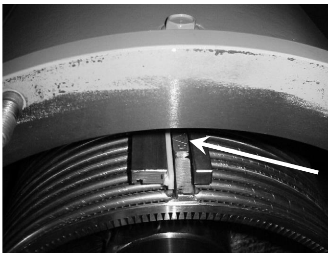
Рис.13-12 Установочное положение сита, отштампованный треугольник сверху и вперед к сепаратору
