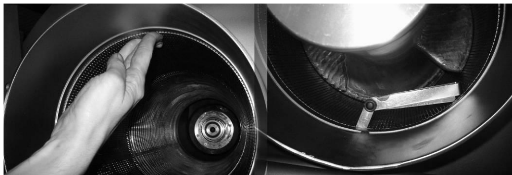
Рис.13-13: Подвижное сито в сепараторе, проверка «плавучести» рукой (слева)
