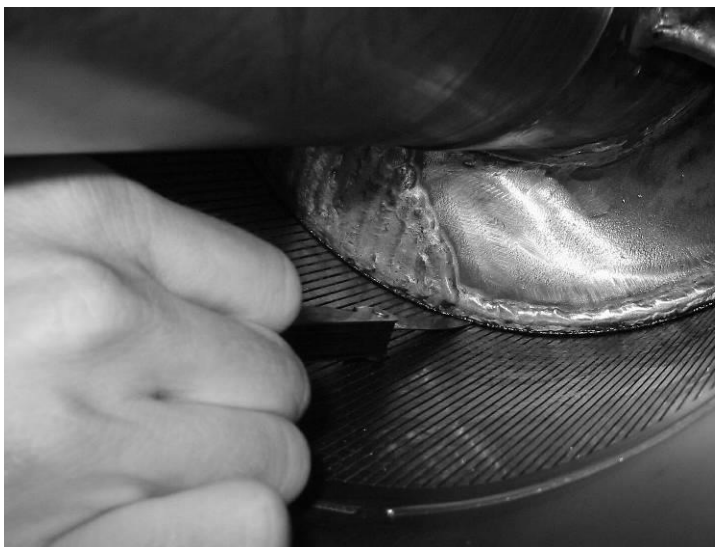
Рис. 13-17 Измерение рабочего зазора между ситом и шнеком, измеряется на нижней стороне сита при остановке машины, измерение показывает двукратный рабочий зазор, так как в состоянии покоя сито лежит
