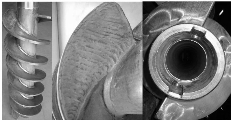
Рис. 13-14: Шнек с твердосплавным специальным облицовочным покрытием и гнездом оси, новое состояние
