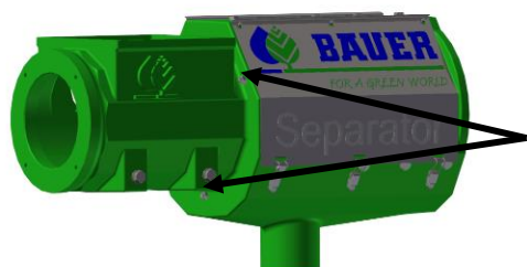
Рис. 13-10 Болты противоизносного кольца
