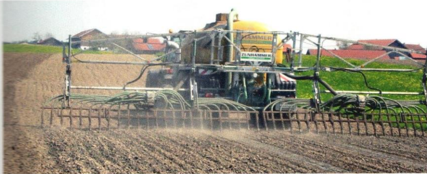
Zunhammer bietet mit dem Farmlandfix-Gleitfußverteiler eine schlagkräftige Lösung für die bodennahe Gülleausbringung.
