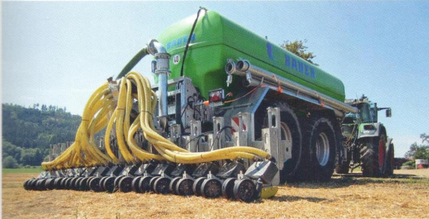
Scheibenschlitzgeräte liefert Bauer meist in Arbeitsbreiten von sechs und acht Meter. Güllegrubber und Güllescheibeneggen werden meist in Arbeitsbreiten von fünf und sechs Meter verlangt.
