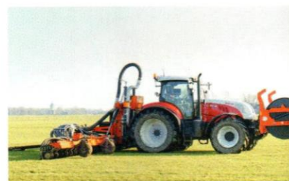
Mit der Verschlauchungstechnik sind die Kosten pro Kubikmeter Ausbringung wegen der Schlagkraft viel günstiger als mit dem Fassverfahren, rechnet Gerrit Schouteren vor.
