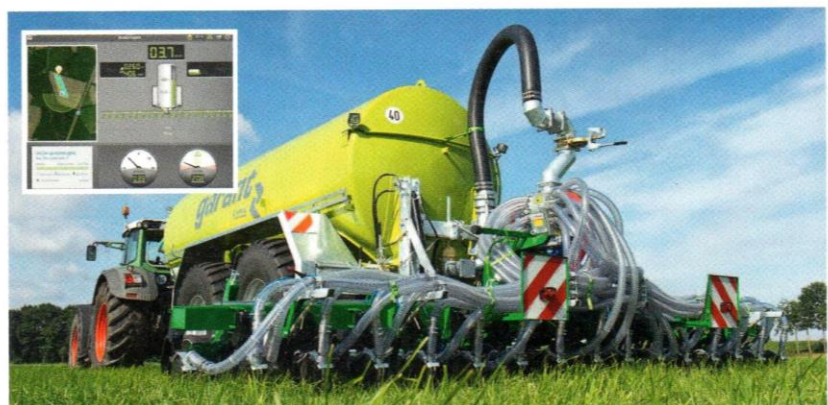
Der SlurryDisc von Kotte ist ein zweibalkiger Injektor mit Doppelscheibenscharen und Striegel. Mit dem SmartControl für iPad lässt sich das Datenmanagement vereinfachen.
