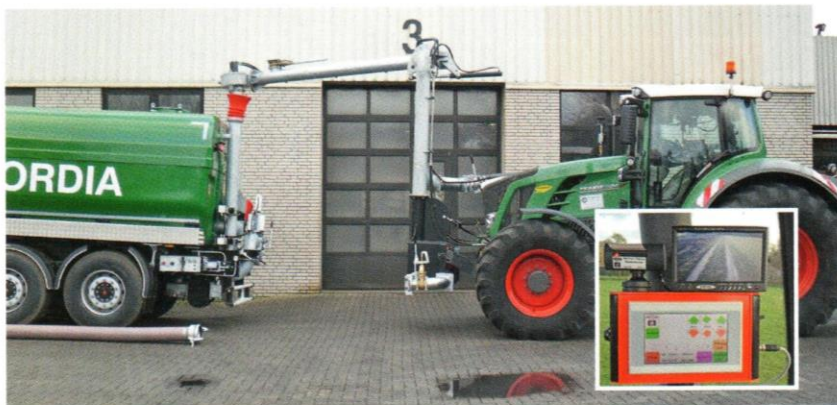
Meyer-Lohne bietet ein komplettes Programm in der Ausbring- und Transporttechnik an einschließlich Frontansaugsrüssel. Der Meytronic-Bordcomputer ermöglicht die Bedienung aller Funktionen des Güllewagens.
