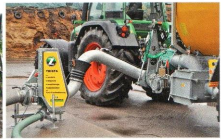
Zunhammer bietet mit dem Farmlandfix-Gleitfußverteiler eine schlagkräftige Lösung für die bodennahe Gülleausbringung.
