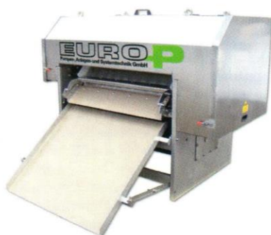
Der Euro-P - Separator arbeitet mit einer Siebtrommel, die unter dem Druck der Abpresswalzen für das Abtrennen aus dem Medium sorgt.
