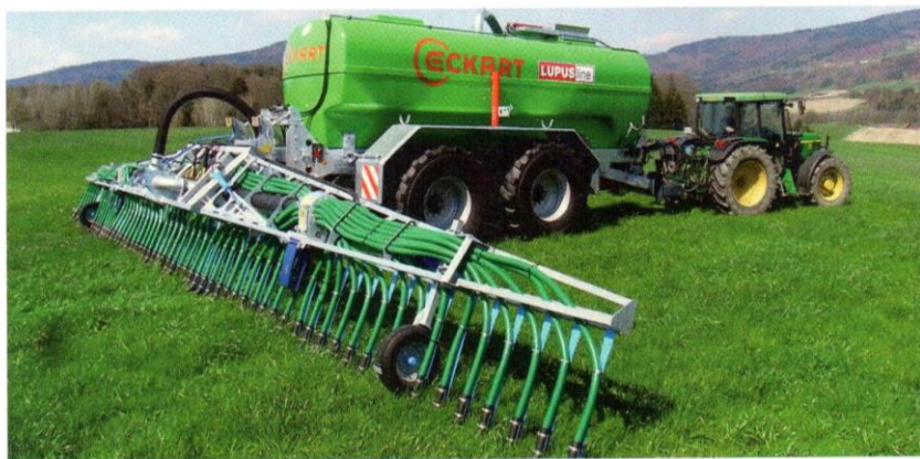
Noch ist die Hälfte der Fasswagen mit konventioneller Technik ausgerüstet, welche jedoch bereits alle Optionen aufweisen, um später auf bodennahe oder Injektionstechnik umrüsten zu können.
