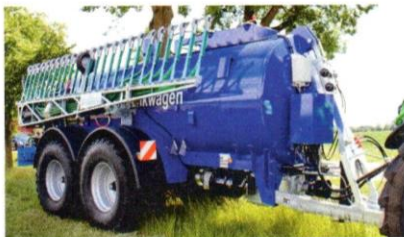
Mit einem Volumen von 5 000 bis 2 000 Litern bietet BSA seine Pumptankwagen in einem sehr weiten Größenspektrum an. Zudem sind die Maschinen je nach Bedarf als Pump- oder Schleudertankwagen lieferbar.
