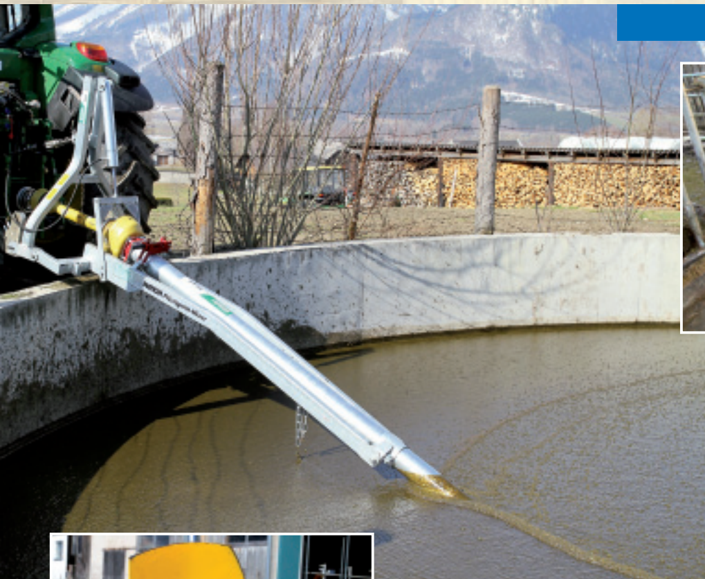
Die Verriegelung des Güllemixers erfolgt über einen Handhebel.
