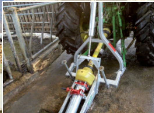
Die Verriegelung des Güllemixers erfolgt über einen Handhebel.
