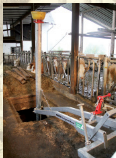
Das Einschwenken des JRE-H wird über einen hydraulischen Zylinder und über eine Neigungsbegrenzungskette bewerkstelligt.
