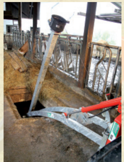
Die Rührstange des TMH 5 Profi wird über ein hydraulisches Hubgestell und eine Handseilwinde eingeschwenkt.
