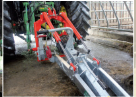
Zum Verriegelung der Rührstange bedarf es etwas Fingerspitzengefühl.
