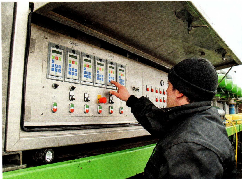
Verkooijen kann alle Pumpen, Ventile und Separatoren zentral steuern. Seine Anlage ist wie geleast, der Umgang mit Gülle verschiedener Betriebe setzt Hygiene voraus.
