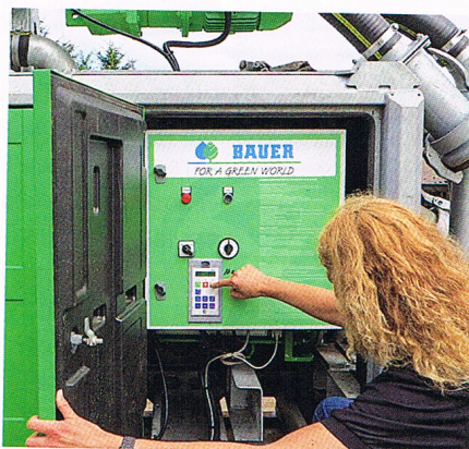
Neben dem Separator und den Pumpen ist auch die elektrische Steuerung in der mobilen Anlage integriert.
