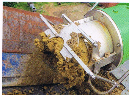
Der Separator ermöglicht bei optimalen Bedingungen Trockensubstanzgehalte von 30 Prozent und mehr.
