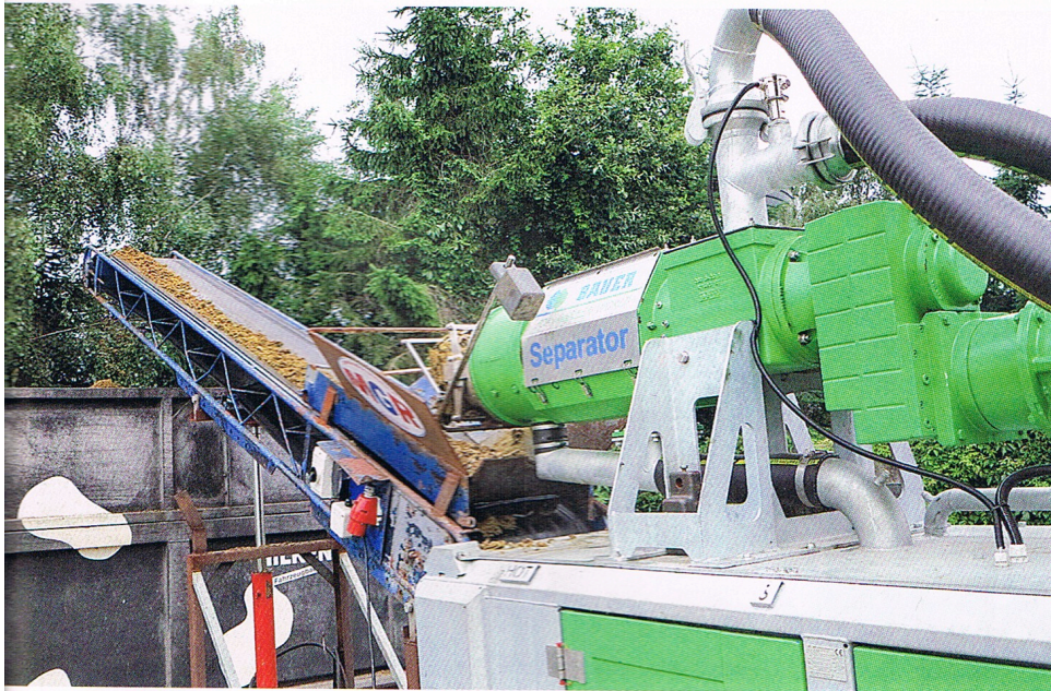
Die Anlage der Maschinengemeinschaft Recke wurde mit einem Förderband ausgestattet, so dass die Feststoffe direkt auf einen Anhänger ügeladen werden können. Fotos: Theißen
