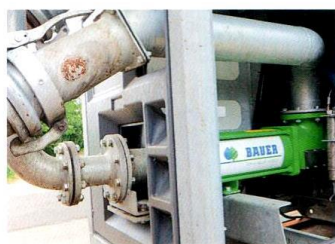
Die Exzenterschneckenpumpe saugt die Gülle aus der Grube und führt sie dem Separator zu.
