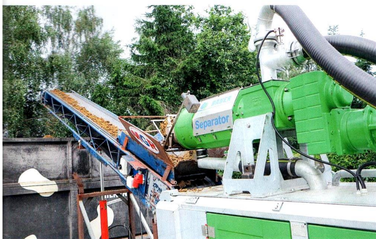
Die Anlage der Maschinengemeinschaft Recke wurde mit einem Förderband ausgestattet, so dass die Feststoffe direkt auf einen Anhänger ügeladen werden können. Fotos: Theißen
