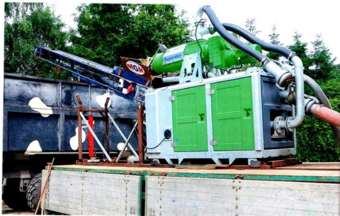
Der Plug & Play-Separator lässt sich auf einem Anhänger oder mit eigenem Fahrwerk transportieren.
