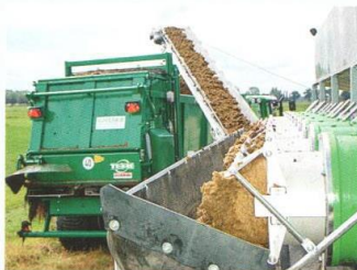
Die Leistung der Separatoren ist so hoch, dass die Dungstreuer zum Verteilen der Feststoffe direkt befüllt werden können.
