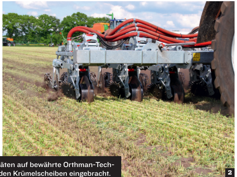
2 Der X-Till von Vogelsang kommt in bis zu 6 m Breite. Trotz der tiefen Bearbeitung von bis zu 30 cm bleibt er leichtzügig.
