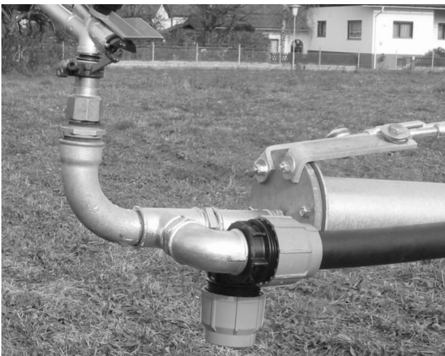
Die PE-Rohrleitung von der Druckerhöhungspumpe zum Endregner wird mit Schellen am Überhangrohr befestigt.
