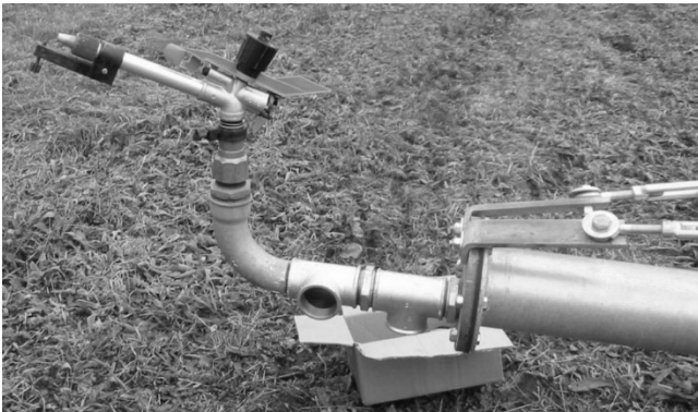
Montage des Endregners mit Anschluss für eine Druckerhöhungspumpe.
