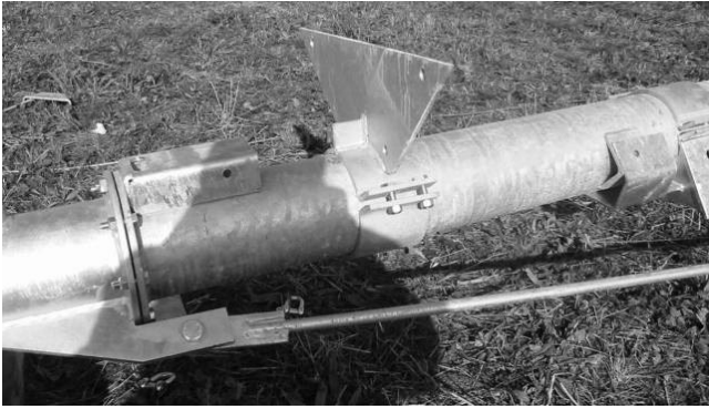
Überhangschelle montiert
