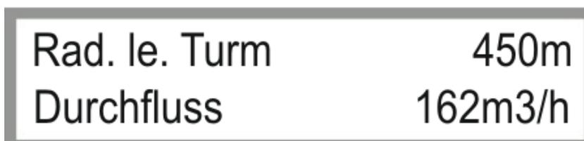
Bild 2.29 Parameter Radius letzter Turm & Durchfluss
