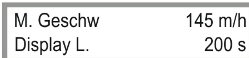
Bild 2.31 Einstellen der Max Geschwindigkeit und der Hintergrundbeleuchtung
