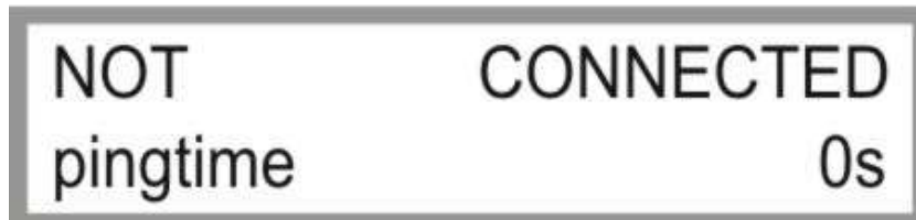
Bild 4.19: Anzeige Verbindungsstatus GPRS-Modem
