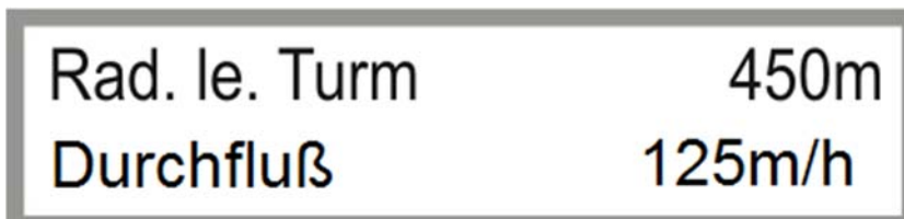
Bild 5.5: Parameter Radius letzter Turm und Durchfluss
