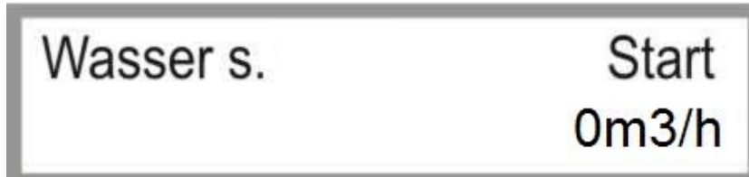
Bild 4.17: Anzeige Wasserverbrauch seit Start
