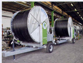
Trommelregnerproduktion im Stammwerk in Voitsberg: Jede Maschine wird auftragsbezogen produziert.
