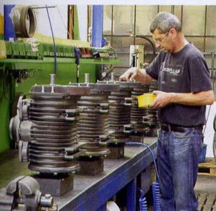
Pumpen und Turbinen erhalten nach der Produktion eine Seriennummer und werden einzeln geprüft.
